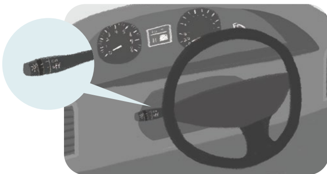
方法3：前後撥動方向盤後的撥桿，以閃爍大燈。
