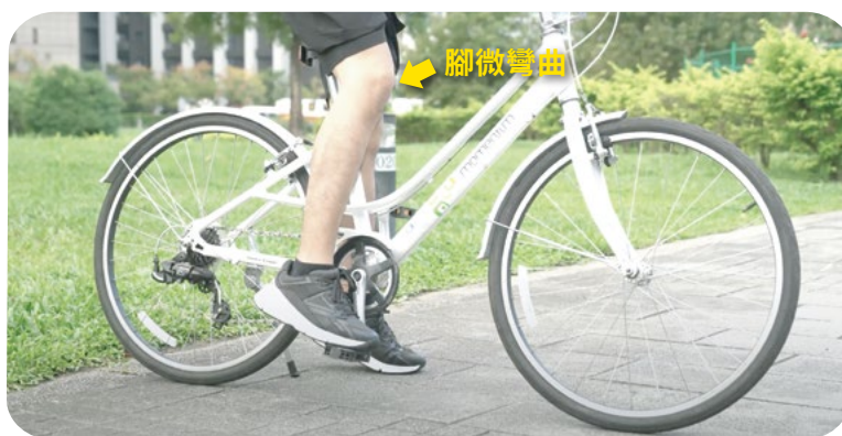
圖5-3-1 自行車初學者的坐墊高度調整
