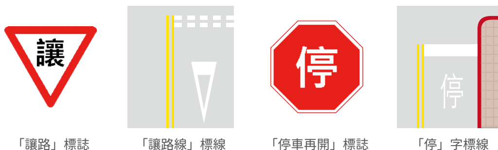
圖5-3-7 設置於支線道的交通標誌、標線
